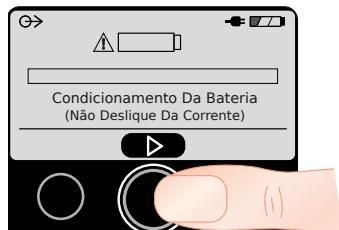
**Nota: antes da primeira utilização da unidade é necessário condicionar a bateria. Se não se condicionar a bateria, o funcionamento desta não será fiável.**
